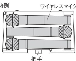
マイク収納ケースの深さを超えて収納しない。また、ワイヤレスマイク収納時は、付属のソフトケースに入れない。マイク収納ケースが引き出せなくなり破損の原因となります。
