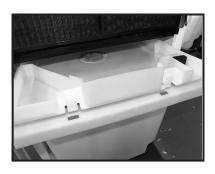
4 タンクフタ、水フィルタを組み付けてタンクを元の位置に確実に取り付けてください。この時、タンク下部のホースが折れないよう注意してください。ホースが折れると、循環水量が減り、水切れ検知が作動したり、冷却性能が低下するおそれがあります。水位ホースが確実に受けに固定されていることを確認してください。水位ホースが外れて奥に入り込み、気がつかずに給水すると、大量の漏水事故に繋がるおそれがあります。
