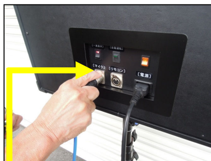
＜計測マイクケーブルを外す＞ 金具ピンを押しながらプラグを抜く
