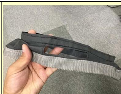
スカートのクリップ取り付け用の窓の位置を合わせて、スカートを被せてベルクロで固定すると完成。
