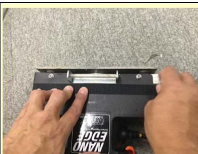
ベースクリップから2mm程隙間をあけ、マジックテープを貼り付ける。
